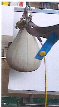
Abbildung 12: Versuchsaufbau mit Glaskugelsack – Anprallpunkt 5
