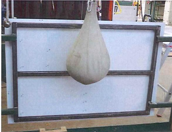
Abbildung 15: Versuchsaufbau mit Glaskugelsack – Anprallpunkt 1
