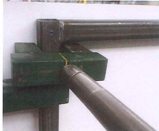
Abbildung 24: Versuchsaufbau - Prüfung der aufnehmbaren Linienlast (2)
