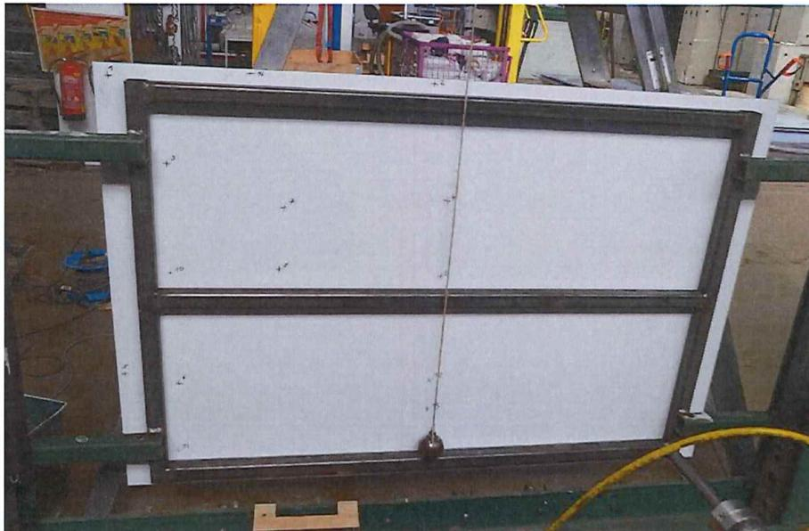
Abbildung 18: Auftreffstellen zur Bestimmung des harten Stoßes – System Delitzsch
