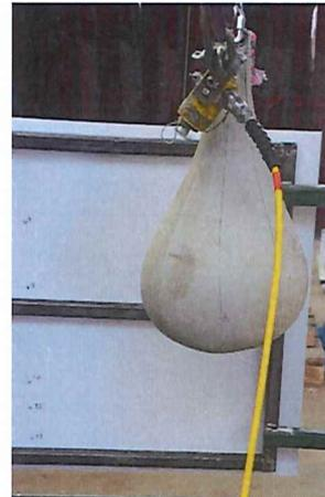
Abbildung 16: Versuchsaufbau mit Glaskugelsack – Anprallpunkt 2
