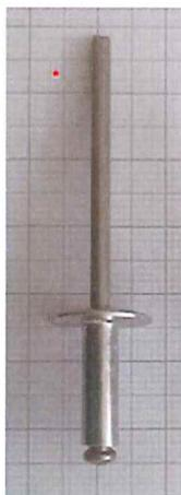
Abbildung 6: Fassadenniet 5 x 16 mm
